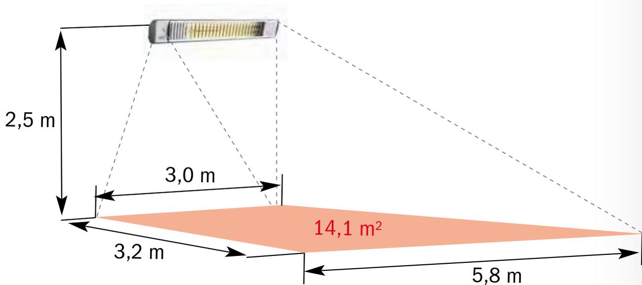
Langwellige Infrarot-Heizplatten, HEATPANELS, haben einen Wärmeradius von etwa 10 qm pro 500 Watt in Innenräumen.
